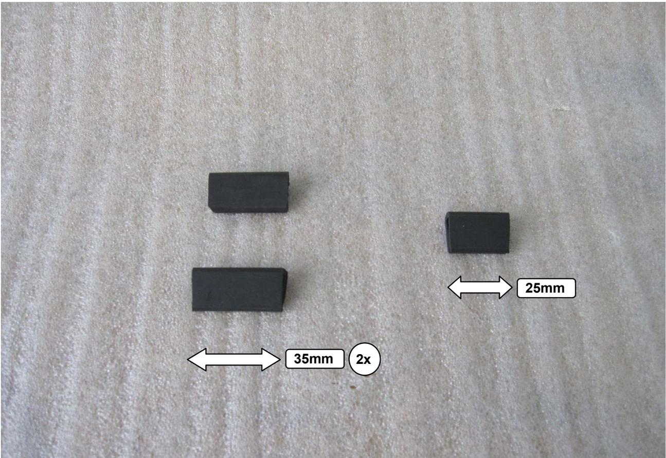
**1** Kantenschutzprofil zuschneiden! / *Cut edge protection profile!*
