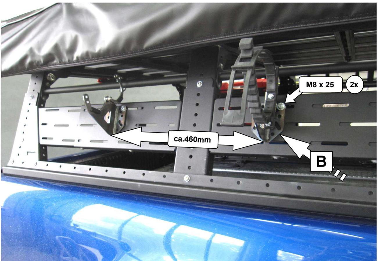
**6** Halter rechts montieren! / *Mount the bracket right!*
