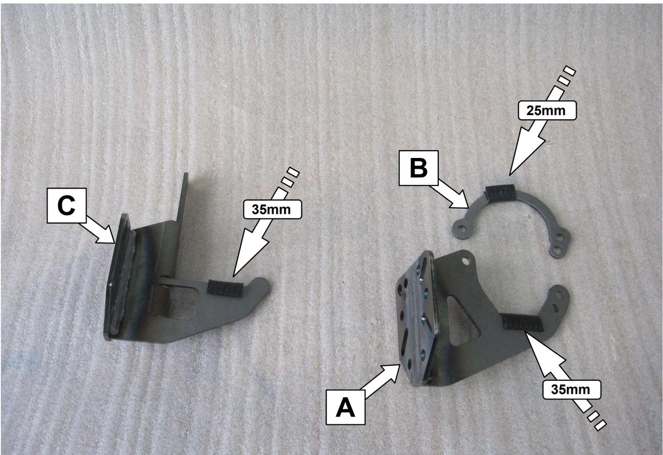
**2** Kantenschutzprofile aufstecken!
